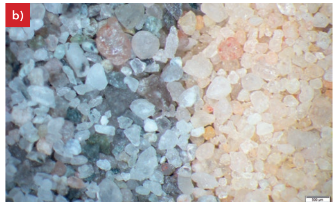
Abb. 6: a) KWS - Wüstensand, b) Schlemmsand 0/1 - Wüstensand (Mikroskopaufnahmen mit 18-facher Vergrößerung)
