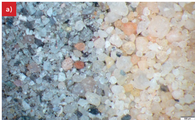
Abb. 6: a) KWS - Wüstensand, b) Schlemmsand 0/1 - Wüstensand (Mikroskopaufnahmen mit 18-facher Vergrößerung)
