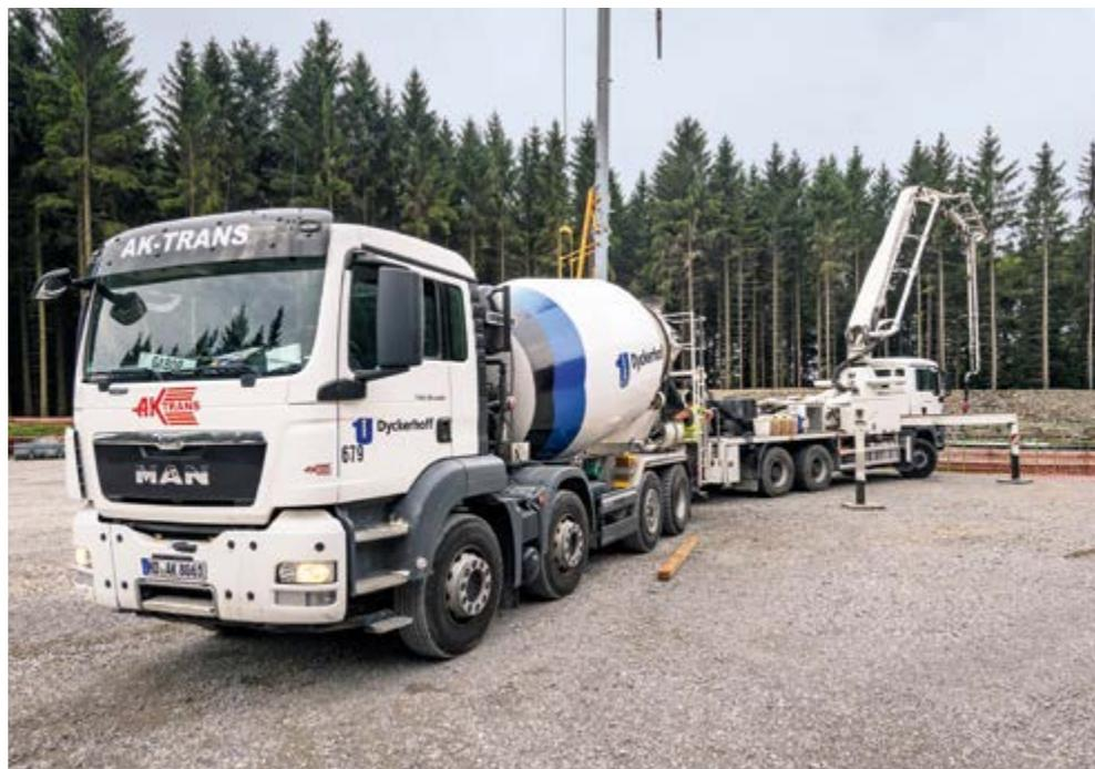
Für ein Windenergieanlagenfundament werden häufig rund 1.000 cbm Transportbeton benötigt.
